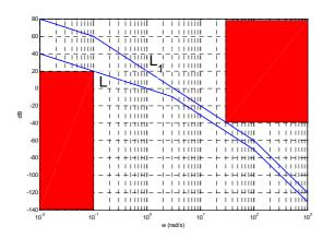
Tracciandone il diagramma di Bode del modulo, ci si rende subito conto, dal taglio dell'asse a 0 dB con pendenza -2, che il margine di fase è negativo o del tutto insufficiente. Si sceglie allora di tagliare alla pulsazione 1, mantenendo il diagramma di |L| parallelo a quello di  $|L_1|$  in bassa frequenza, aggiungendo un polo alla pulsazione 3 e mantenendo il polo alla pulsazione 100. In questo modo sono facilmente soddisfatti anche i vincoli di attenuazione dei disturbi.
