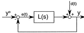
dove  $d(t) = \sin(0.06t - \pi/12)$  e  $L(s)$  ha il seguente diagramma del modulo e della fase
