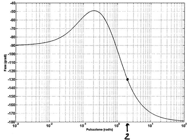
1.1 Si determinino  $\omega_c$  e  $\varphi_m$ , e si discuta la stabilità del sistema in anello chiuso.
