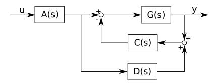
Assumendo A(s)=2, C(s)=1 e  $D(s)=\frac{1}{s},$  si determini la funzione di trasferimento da u a y.
