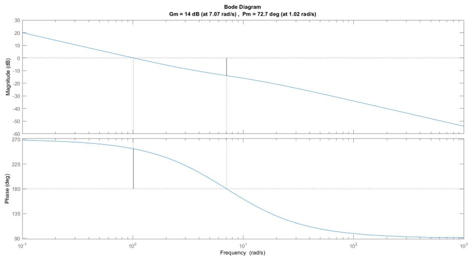
Figura 1: Diagramma di Bode di  $L(s)$ .
