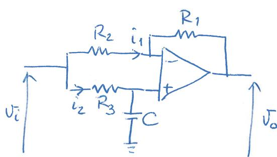
$$\begin{cases} i_2 = \frac{C \frac{dV_c}{dt}}{R_3} \\ i_2 = \frac{V_i - V_c}{R_3} \end{cases}$$
