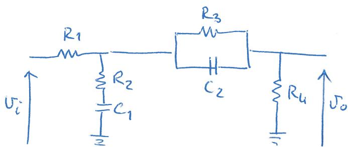
No, perché ora il secondo filtro assorbe corrente dal primo, quindi la funzione di trasferimento cambia (e' utile provare a calcolarla anche se un po' noioso).
