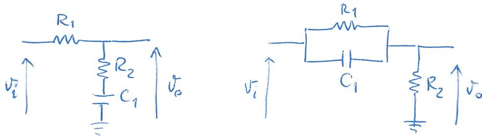
Determinare le funzioni di trasferimento  $F(s) = \frac{V_o(s)}{V_i(s)}$  e tracciarne il diagramma di Bode del modulo e della fase.
