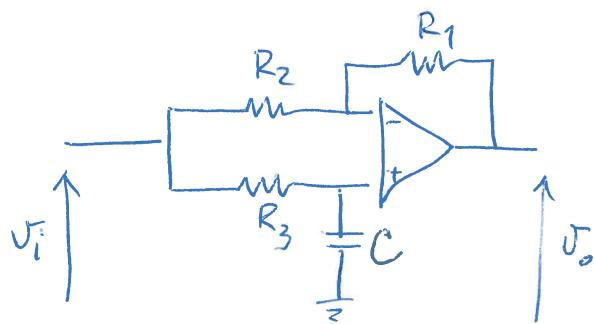
Determinare la funzione di trasferimento del circuito.
