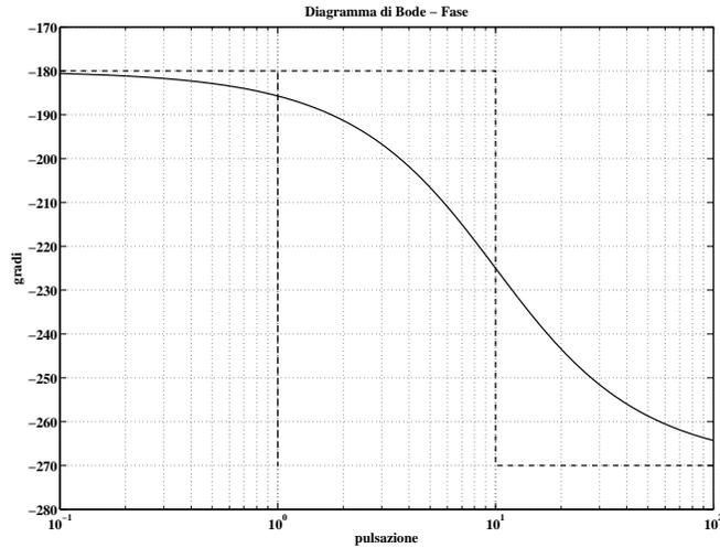
Figura 2: Diagramma di Bode della fase di  $G(s)$ .
