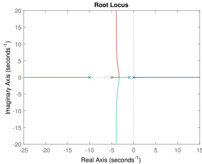
3. Si determini con il luogo delle radici il valore  $\bar{\mu}$  di  $\mu$  per cui uno dei poli in anello chiuso si trova nel punto  $\bar{s} = -0.2$ , spiegando se per tale valore il sistema in anello chiuso è asintoticamente stabile.
