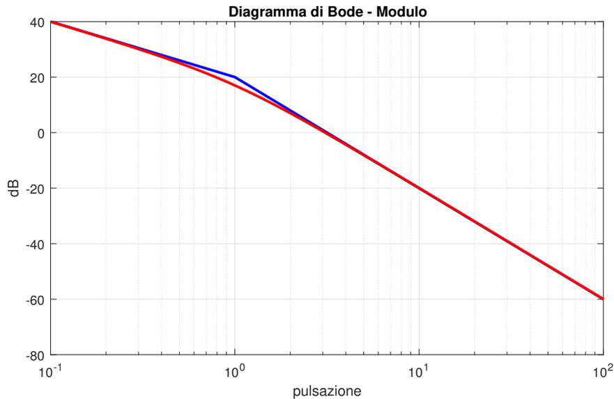
e dal diagramma di Bode del modulo in figura si può leggere il valore di  $\omega_C \cong 3 \text{ rad/s}$ . Ponendo  $\Omega_C = 2\Omega_N = 20\omega_C = 60 \text{ rad/s}$ , il valore da scegliere per il periodo di campionamento è dunque
