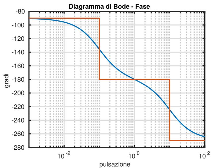
Per il tracciamento del modulo di  $L$  si osservi che, supponendo  $\omega_c = 1$ , occorrerà introdurre due poli in 0.01, due zeri in 0.1 ed un polo in 10, mantenendo inoltre quello già presente in  $L_1$ . La funzione di trasferimento d'anello risulta quindi:
